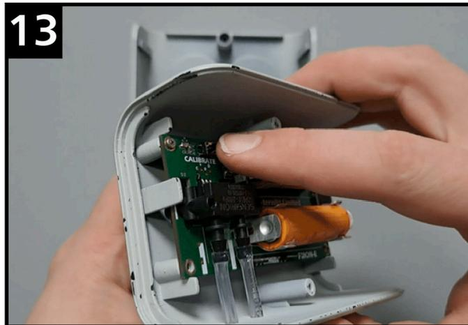
**ステップ 13.** ホースが接続され、ユニットの電源が入り、正しい方向に回転したら、回路基板のキャリブレーションボタンを押します。最初の 10 秒間はモニターが較正され、気流が動的に感知されるため、緑色の点灯が 2 分間続きます (青色のライトが点滅している場合は、ホースの接続が間違っている可能性があります)。
