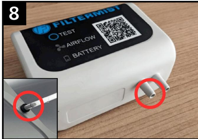
ステップ8. ペンで印をつけたホースをダイアフラムのノズルに接続する。次にモニター下部の左側のノズルに接続します。
