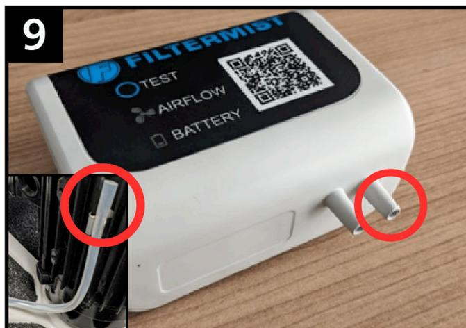
ステップ9. もう一方のホースを、ホースが上を向くようにモータークリップを使ってモーターに接続します。そしてモニター下部の右側のノズルに固定します。
