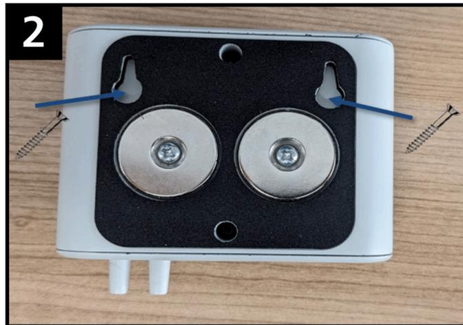
ステップ 2. または、平らな垂直面に 60mm の間隔で 2 本のネジを固定し、モニターをネジに引っ掛ける。ネジ山の最大直径は 3.5mm、頭の最大直径は 8.5mm。
