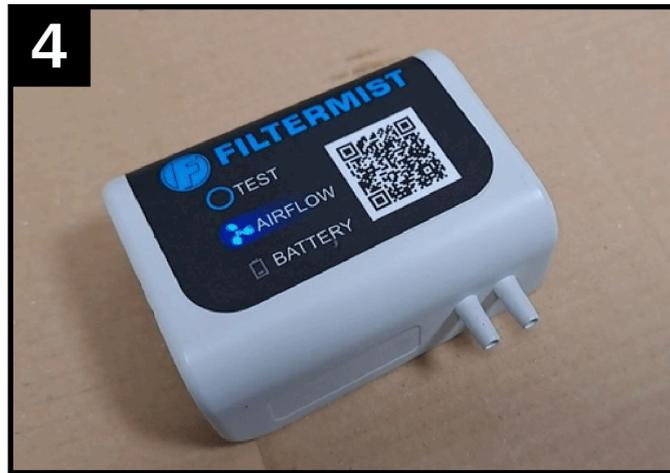
ステップ 4. 始動時、エアフローライトとバッテリーライトの両方が 2 回点滅します。その後、エアフローランプが青く点滅し続けます。これは、本機が未校正であることを示します。
